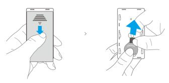
出厂时,RM433R2遥控器已与 iFan04 进行绑定,取出遥控器电池绝缘片之后即可进行控制,如不能控制,请尝试重新学习。
