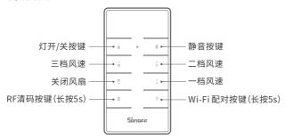
**RF清码方法:** 长按RF清码按键5秒至设备蜂鸣器发出"滴滴"两声,即完成清码。
