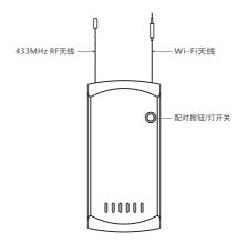
①设备重量<1kg,建议安装高度<2米。
